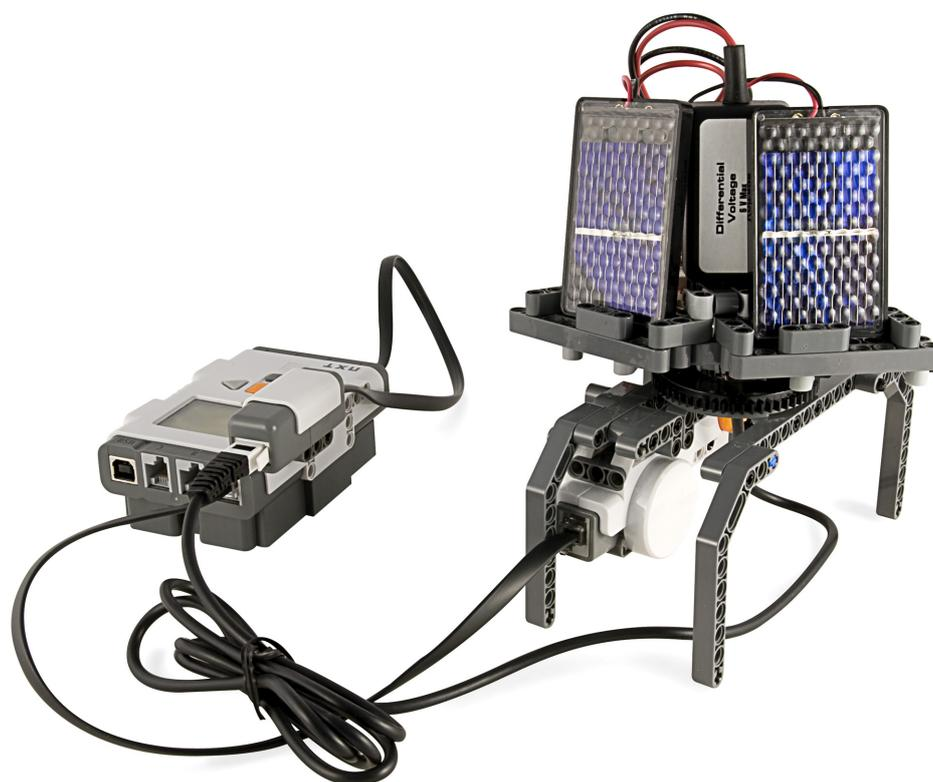
図1. LEGO社製ミニ太陽パネルを用いた太陽追尾装置の一例
