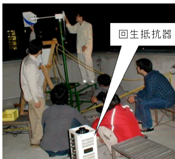
図 1-9. 回生抵抗器を利用した実験
