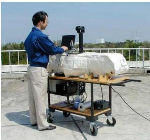
図 8. ドブソン分光計による観測（気象庁）
