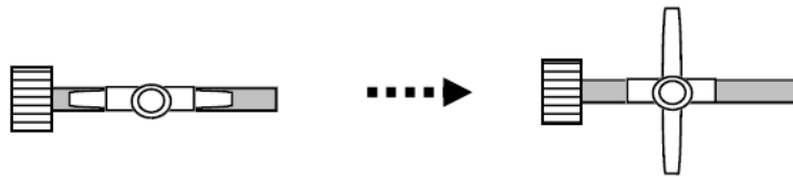
図15. コック『開』の状態（左）とコック『閉』の状態（右）
